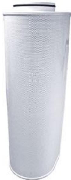
Круглые воздухораспределители низкоскоростные 1ВНП предназначены для подачи воздуха непосредственно в рабочую зону помещения с малой скоростью и малым температурным перепадом ( $\Delta t = 3^{\circ}\text{C}$ ), обеспечивающими принцип вытесняющей вентиляции.
