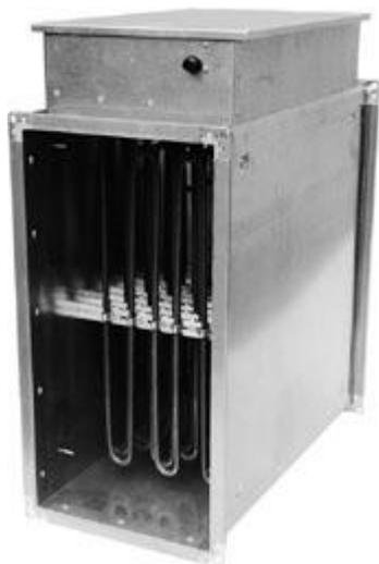
Канальные нагреватели PBER предназначены для подогрева воздуха в воздуховодах прямоугольного сечения. Корпус и коммутационная коробка изготовлены из оцинкованного стального листа, нагревательные элементы — из нержавеющей стали. Степень защиты: IP 40.
