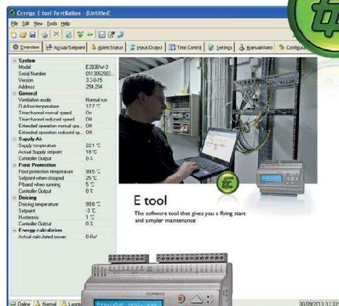
*Corrigo также может быть настроен непосредственно через дисплей и кнопки без использования ПК; практичный способ ввода в эксплуатацию, хотя E tool<sup>®</sup> предлагает лучший обзор.*
