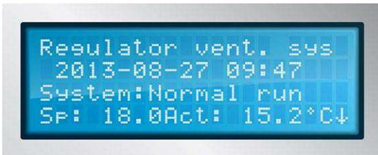
Дисплей имеет 4 строки по 20 знаков в каждой и подсветку, обеспечивающую простое считывание независимо от уровня освещения в помещении.
