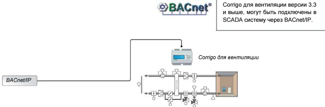
Corrigo для вентиляции версии 3.3 и выше, могут быть подключены в SCADA систему через BACnet/IP.
