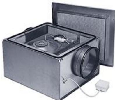
Все канальные вентиляторы IRE оборудованы асинхронным двигателем с внешним ротором и уплотнёнными подшипниками, что увеличивает срок их службы. Корпус изготавливается из гальванизированной стали. Двигатель и рабочее колесо вентиляторов расположены на откидывающейся пластине, что делает доступ к ним лёгким, быстрым и удобным. Вентиляторы имеют внутренний 50 мм слой изоляции из минеральной ваты, покрытой грубой шерстяной тканью, что обеспечивает низкие шумовые характеристики.
