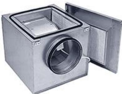
Все канальные вентиляторы IRE оборудованы асинхронным двигателем с внешним ротором и уплотнёнными подшипниками, что увеличивает срок их службы. Корпус изготавливается из гальванизированной стали. Двигатель и рабочее колесо вентиляторов расположены на откидывающейся пластине, что делает доступ к ним лёгким, быстрым и удобным. Вентиляторы имеют внутренний 50 мм слой изоляции из минеральной ваты, покрытой грубой шерстяной тканью, что обеспечивает низкие шумовые характеристики.
