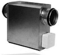
Канальные вентиляторы LPK/LPKI имеют типоразмеры от 100 до 200 мм и предназначены для установки в круглых каналах. Все вентиляторы оборудованы асинхронными двигателями с внешним ротором и уплотнёнными подшипниками, что увеличивает срок их службы. Корпус изготавливается из гальванизированной стали. Для снижения распространения шума в окружающее пространство крышка вентилятора LPKI снабжена слоем изоляции толщиной 30 мм. Степень защиты электродвигателя IP 44, клеммной колодки -54.
