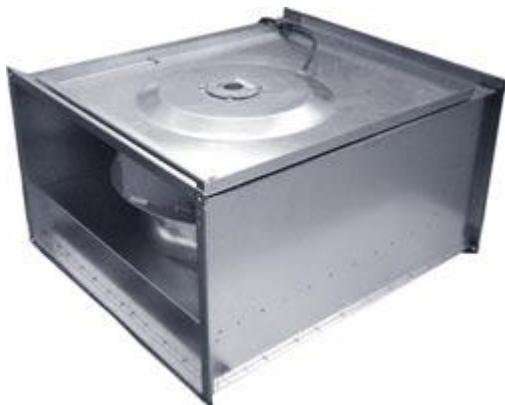
Все канальные вентиляторы RKB оборудованы асинхронным двигателем с внешним ротором и уплотнёнными подшипниками, что увеличивает срок их службы. Корпус изготавливается из гальванизированной стали. Все вентиляторы снабжены рабочим колесом с загнутыми назад лопатками. Двигатель и рабочее колесо вентилятора расположены на откидывающейся пластине, что делает доступ к ним лёгким, быстрым и удобным. Степень защиты электродвигателя IP44, клеммной колодки - IP54.
