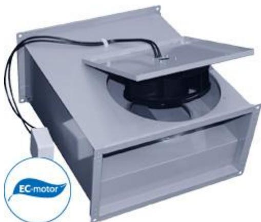
Канальные вентиляторы RKB EC оборудованы электронно-коммутируемым двигателем (ЕС-двигателем) с внешним ротором и рабочим колесом с загнутыми назад лопатками. Двигатель и рабочее колесо вентилятора расположены на откидывающейся пластине, что делает доступ к ним лёгким, быстрым и удобным. Корпус вентилятора изготавливается из гальванизированной стали.
