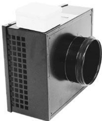
Канальные вентиляторы RS имеют типоразмеры от 100 до 160 мм и предназначены для установки в круглых каналах. Все вентиляторы оборудованы асинхронными двигателями с внешним ротором и уплотнёнными подшипниками, что увеличивает срок их службы. Вентиляторы изготавливаются из стали и окрашиваются методом порошкового напыления в черный цвет. Степень защиты электродвигателя IP 44, клеммной колодки - IP 54.
