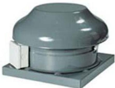
Крышные вытяжные вентиляторы оборудованы асинхронным двигателем с внешним ротором, рабочим колесом с загнутыми назад лопатками и уплотнёнными подшипниками, что увеличивает срок их службы. Вентиляторы имеют откидывающуюся верхнюю часть (крышка с двигателем и рабочим колесом). Корпус вентиляторов изготавливаются из гальванизированной стали. TKS — вентиляторы с горизонтальным выбросом воздуха.
