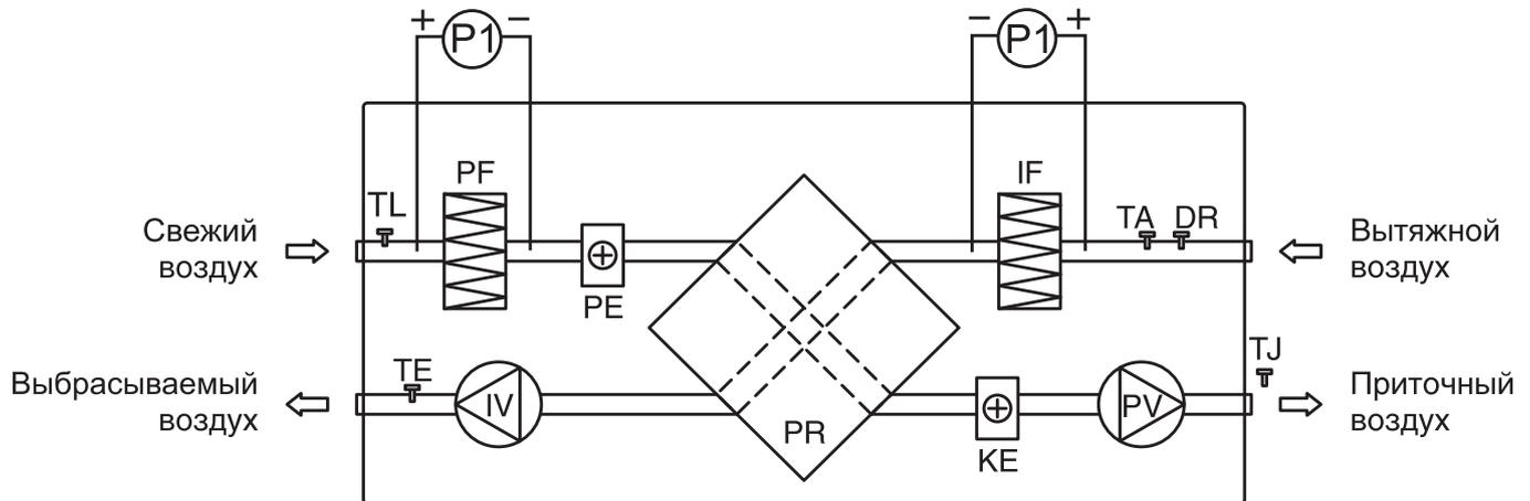
PV — вентилятор приточного воздуха;
