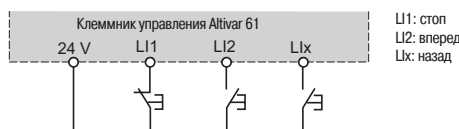
Схема соединений при трехпроводном управлении
