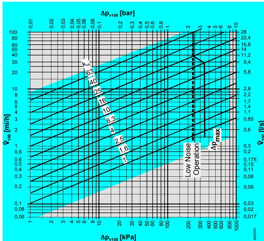
$\Delta p_{\max}$  = максимально допустимый перепад давления через клапан, при работе с моторным приводом. Для низкого уровня шума рекомендуемый максимальный перепад давления **200 kPa**
