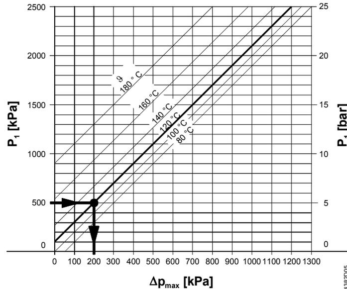
$\Delta p_{max}$  = перепад давления, при котором шаровой клапан почти закрыт, и можно избежать кавитацию
