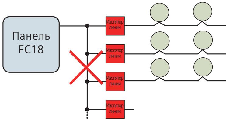
2.3.8 Пример недопустимого подключения изолятора линии (Вариант В)
