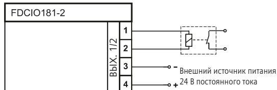
Схема подключения для инверсных подключений, например, при управлении замковым устройством двери.
