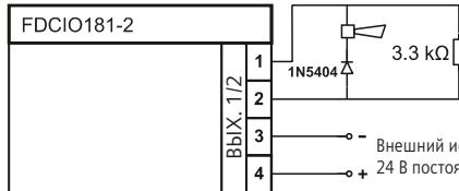
Подключение для нормальной работы; обеспечивается контроль исполняемой цепи на обрыв и короткое замыкание.
