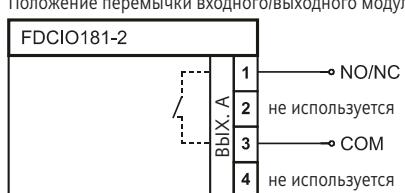
Схема подключения для «сухого» выходного контакта.
