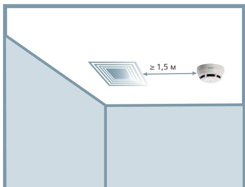
Размещение извещателя рядом с вентиляционным отверстием\*.
