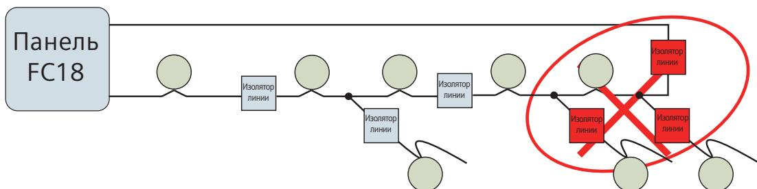
2.3.9 Пример недопустимого подключения изолятора линии (Вариант С)
