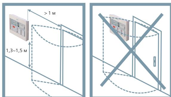
Монтаж панелей управления противопожарной сигнализацией\*. Сохраняйте минимальное расстояние до объектов, которые могут перекрыть панель или скрыть ее из вида.
