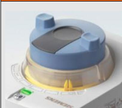
Простое управление в период опрессовки и балансирования установки, экстренных случаев и сервисных мероприятий. Вращая рукоятку ручного управления, Вы можете полностью открыть или закрыть клапан без применения сторонних приспособлений. Система ручного управления защищена от прилагаемых сверх усилий и от прокручивания при достигнутом крайнем положении.
