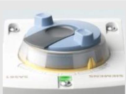
Для временного позиционирования клапана в нужном положении необходимо лишь нажать и повернуть рукоятку ручного управления. Отпустив рукоятку, привод автоматически возвратится в исходное положение. Для ручной фиксации привода в требуемом положении на продолжительное время сдвиньте слайдер на верхней части рукоятки.
